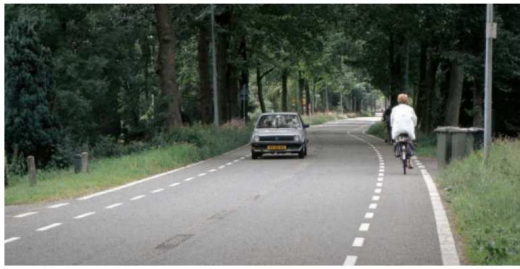
Ilustración nº 23: Ejemplo de banda de protección, eliminando a línea central da calzada
